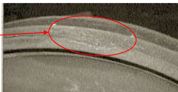
Slika 9 Veliko neenakomerno zavaljanje preko oboda kolesnega venca
