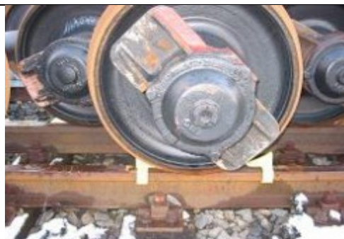
Slika 2: skladiščenje na zamaknjenem tiru s pomočjo zagozd
