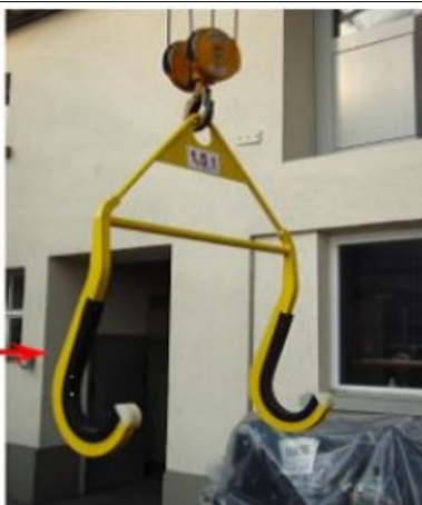
Slika 1: naprava za transport kolesnih dvojic (dvig z oprijemom na osi)
