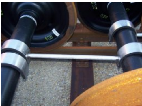
Slika 7: skladiščenje na dvojnem tiru s pomočjo distančnikov
