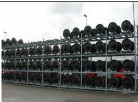
Slika 5: skladiščenje z zlaganjem s pomočjo podstavka za transport kolesnih dvojic
