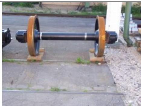
Slika 6: posamično skladiščenje s pomočjo podstavka posamične osi
