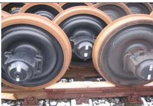
Slika 3: skladiščenje na zamaknjenem tiru (dvojne tirnice)
