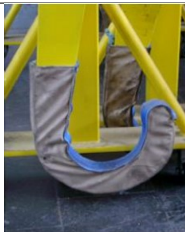
Slika 2: naprava za transport kolesnih dvojic, snemljiva zaščita
