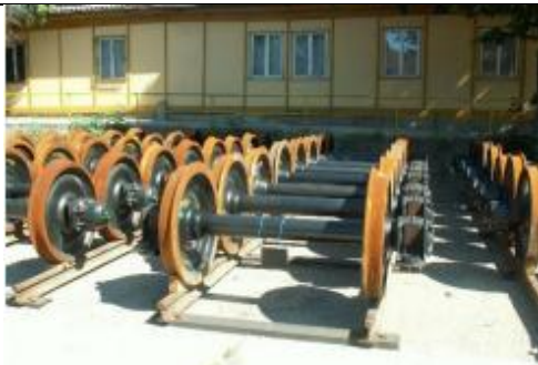
Slika 1: skladiščenje na tiru s pomočjo zagozd
