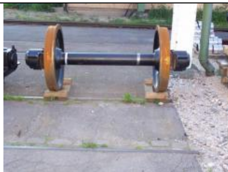
Slika 6: posamično skladiščenje s pomočjo podstavka posamične osi
