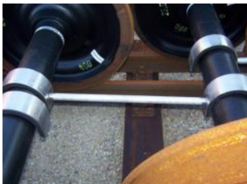
Slika 7: skladiščenje na dvojnem tiru s pomočjo distančnikov
