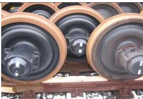
Slika 3: skladiščenje na zamaknjenem tiru (dvojne tirnice)
