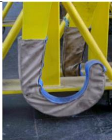
Slika 2: naprava za transport kolesnih dvojic, snemljiva zaščita
