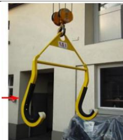
Slika 1: naprava za transport kolesnih dvojic (dvig z oprijemom na osi)
