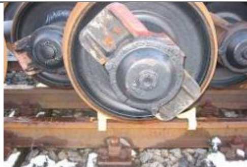
Slika 2: skladiščenje na zamaknjenem tiru s pomočjo zagozd
