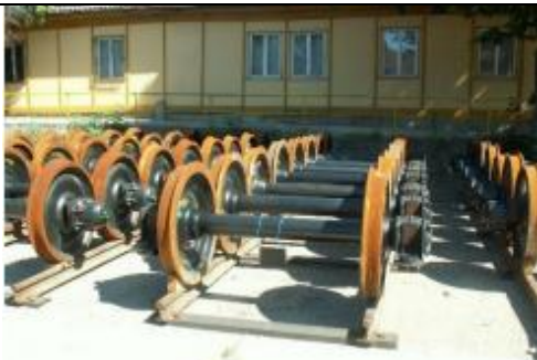
Slika 1: skladiščenje na tiru s pomočjo zagozd
