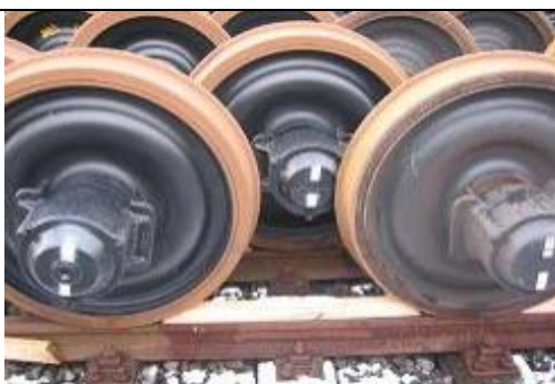
Slika 3: skladiščenje na zamaknjenem tiru (dvojne tirnice)
