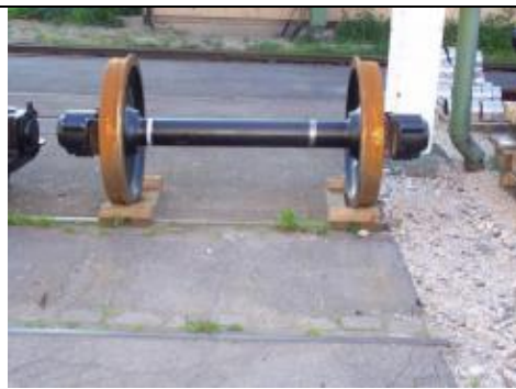
Slika 6: posamično skladiščenje s pomočjo podstavka posamične osi
