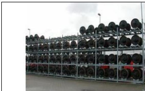
Slika 5: skladiščenje z zlaganjem s pomočjo podstavka za transport kolesnih dvojic
