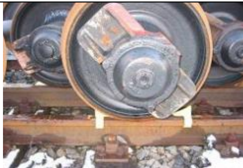
Slika 2: skladiščenje na zamaknjenem tiru s pomočjo zagozd
