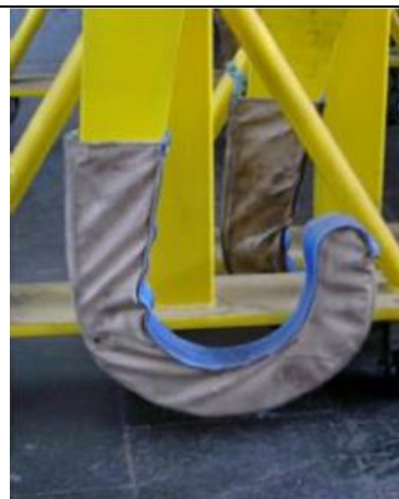
Slika 2: naprava za transport kolesnih dvojic, snemljiva zaščita
