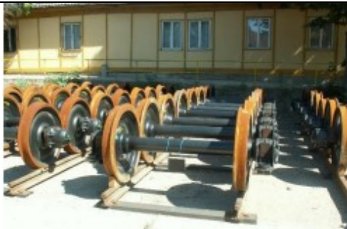
slika 1: skladiščenje na tiru s pomočjo zagozd
