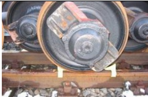
slika 2: skladiščenje na zamaknjenem tiru s pomočjo zagozd
