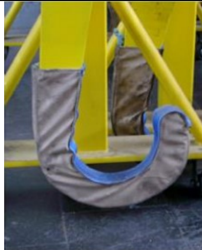
slika 2: naprava za transport kolesnih dvojic, snemljiva zaščita
