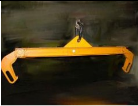
slika 3: naprava za transport kolesnih dvojic (dvig z oprijemom na kolesih)
