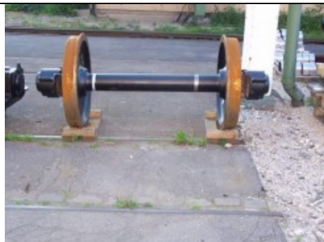
slika 6: posamično skladiščenje s pomočjo podstavka posamične osi
