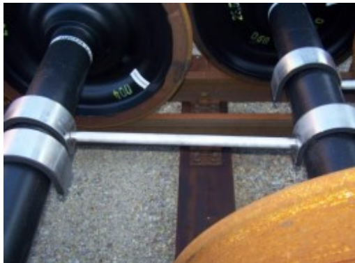
slika 7: skladiščenje na dvojnem tiru s pomočjo distančnikov
