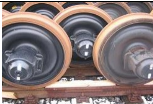
slika 3: skladiščenje na zamaknjenem tiru (dvojne tirnice)
