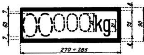
Slika 2: Lastna masa vagona in zavorna masa ročne zavore, s katero se ravna s ploščadi vagona
