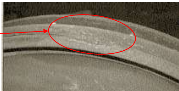
Slika 9 Veliko neenakomerno zavaljanje preko oboda kolesnega venca
