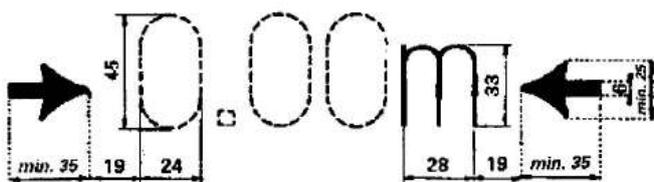
**Namestitev:** Na vsak vzdolžni nosilec desno oz. na vzdolžne nosilce podstavnih vozičkov (zadošča, če se znak namesti na stranico levega podstavnega vozička, na vsaki strani vagona) ali na konstrukcijske dele, ki prekrivajo vzdolžne nosilce, ali na posebne table v višini vzdolžnih nosilcev.
