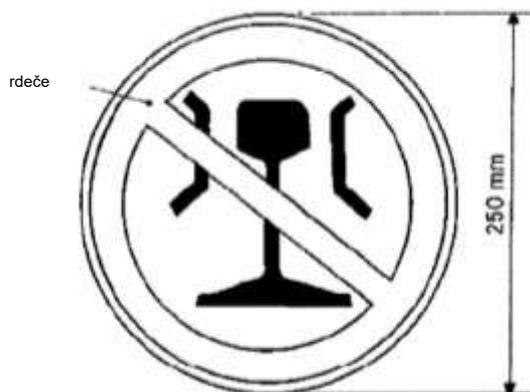
Namestitev: Na vsak vzdolžni nosilec levo ali na konstrukcijske dele, ki prekrivajo vzdolžne nosilce, ali na posebne table v višini vzdolžnih nosilcev.
