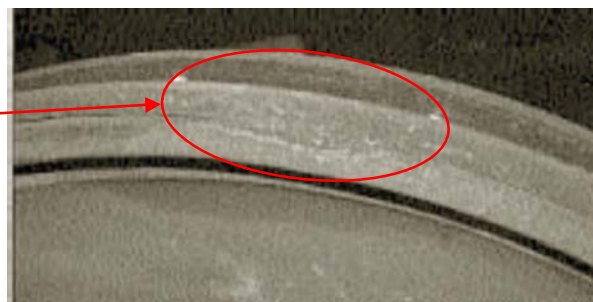
Slika 9 Veliko neenakomerno zavaljanje preko oboda kolesnega venca
