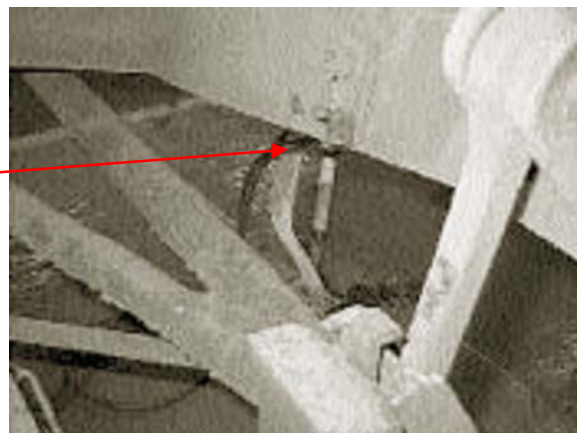
Slika 3 Svetleče podložne ploščice na zavornem trikotu kot posledica obrabljenosti
